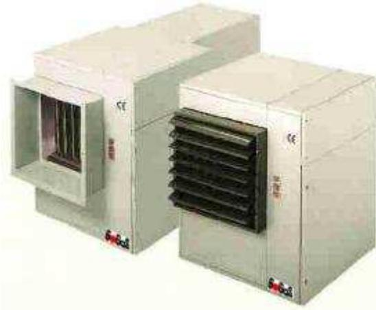
Bei **dezentralen Warmluftherzeugern** wird der gesamte Wärmebedarf auf mehrere kleine Geräte aufgeteilt. Diese bestehen aus einem Stahlblechgehäuse, Wärmetauscher, Gasbrenner, Abgassammelkasten und Abgasstutzen. Zudem ist der Warmluftherzeuger mit einem Ventilator und einem Ausblasrahmen mit verstellbaren Lamellen ausgestattet. Jedes Gerät benötigt weiterhin eine eigene Abgasführung.
